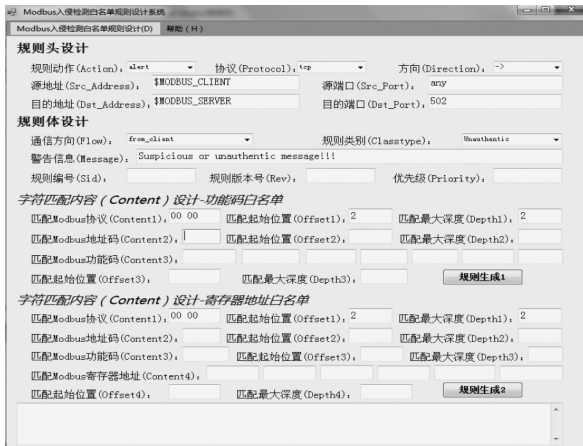
图4 Modbus/TCP异常报文入侵检测白名单规则设计系统界面
